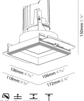
**120 x 120mm 170mm 10 | 12 ½ | 15 | 25mm**  $4^{3}/4'' \times 4^{3}/4'' \quad 6^{11}/16'' \quad 3^{3}/8'' \quad 1^{2}/2'' \quad \%16'' \quad 1''$
